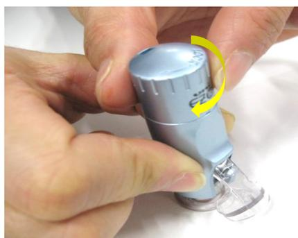
②ホルダーを押し付けたまま外カバーを矢印の方向にねじり、ロックします。
